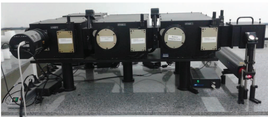
Figura 16. Espectrômetro triplo Princeton utilizado para as medidas de Espalhamento Raman [107].
