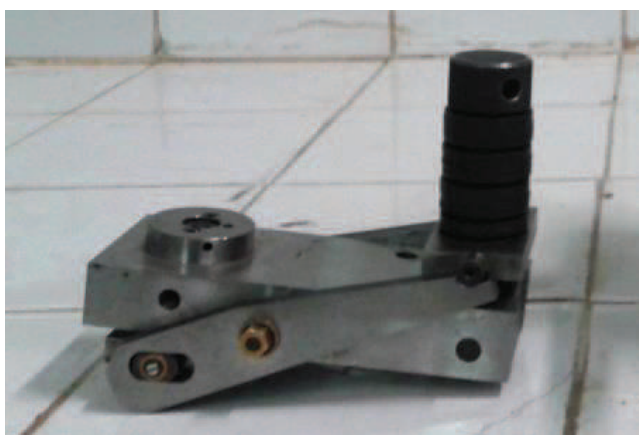
Figura 18. Célula de pressão hidrostática do tipo DAC utilizada nos experimentos de altas pressões[108].
