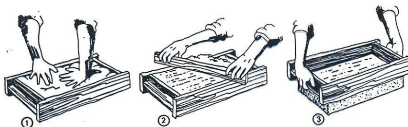
Figura 13 - Sequência de moldagem de um bloco de adobe
