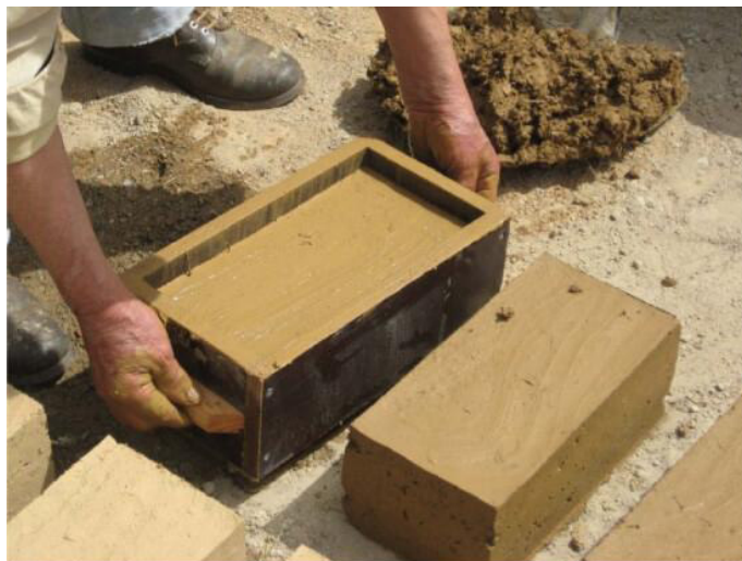
Figura 12 - Produção de bloco de adobe moldado
