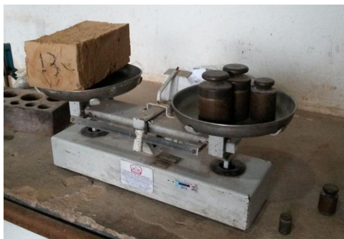
Figura 14 – Bloco T20F13 sendo pesado
