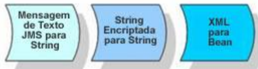
Figura 5: Transformador de entrada. Fonte: Mule ESB, 2006.
