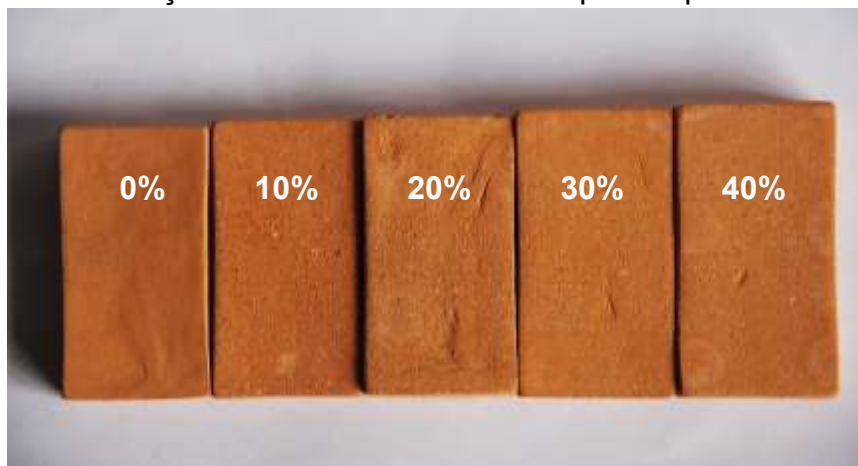
Figura 57 - Variação de volume e tons nos corpos de prova da amostragem
