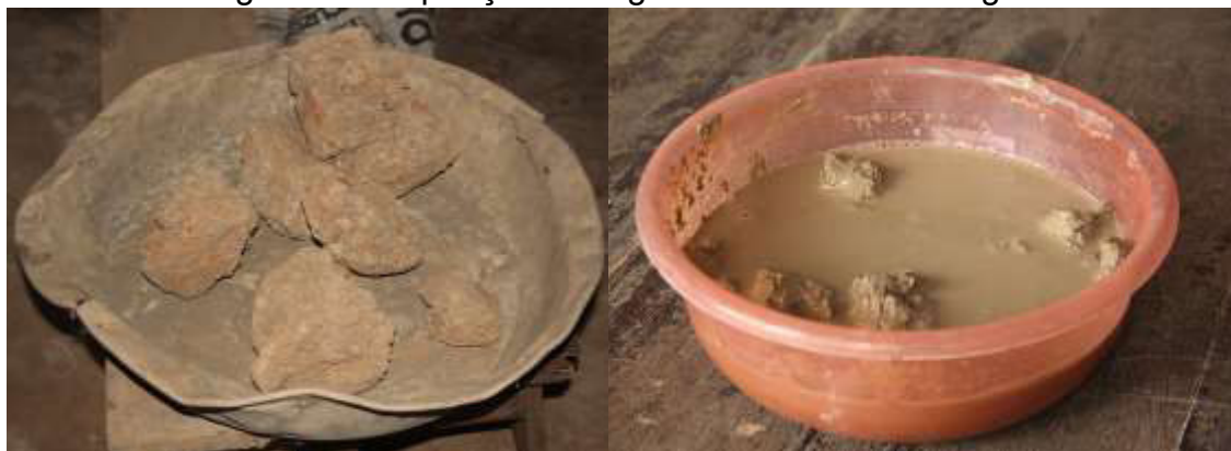
Figura 37 - Aquisição de argila e submersão em água
