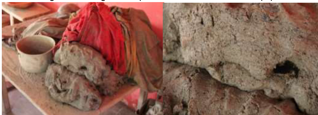
Figura 18 - Argila incorporada com as cinzas do taquipé
