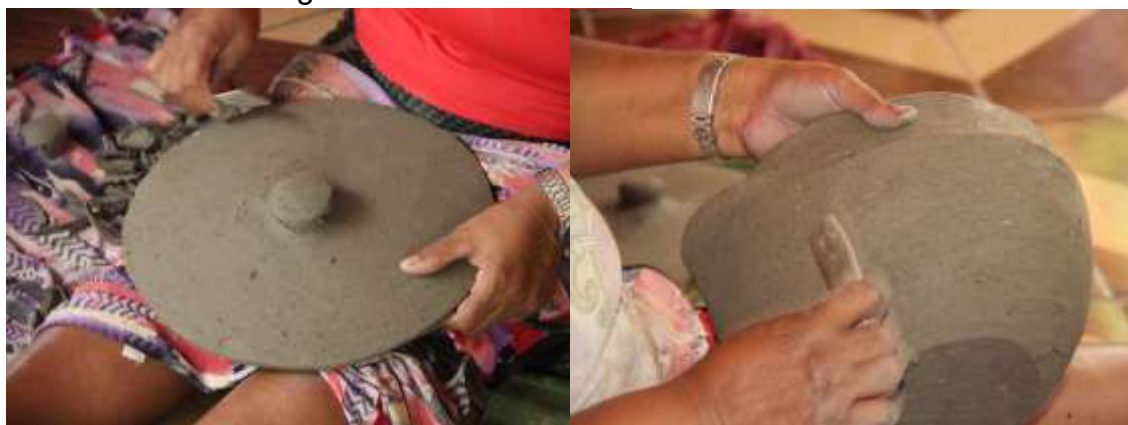
Figura 25 - Acabamentos com ferramentas
