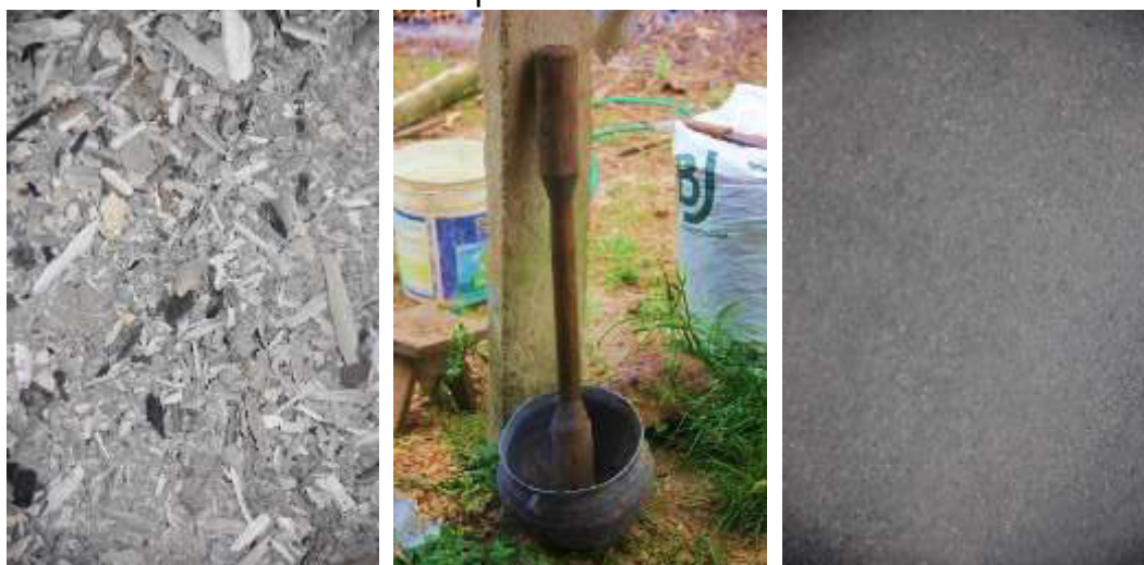
Figura 36 - Pilão para trituração das cascas de taquipé e cinza de taquipé processada
