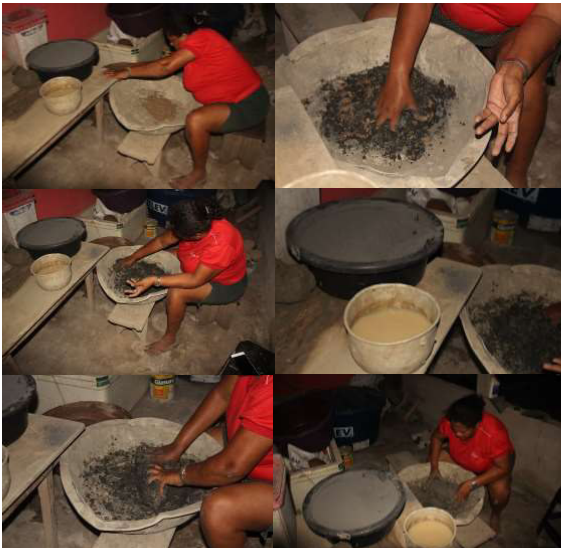
Figura 22 - Processo de incorporação da cinza de taquipé à argila
