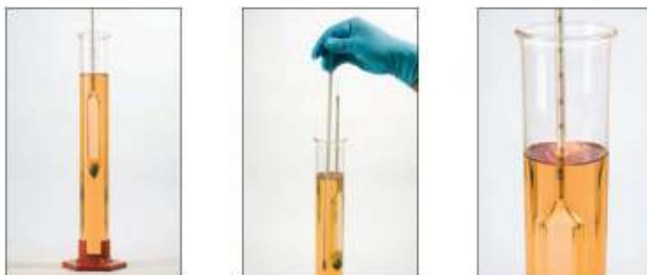
Figura 2.6 – Teste da Massa Específica e Teor Alcoólico (Gasolina) (ANP, 2008)
