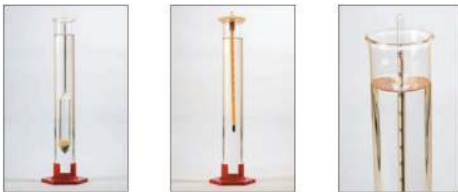
Figura 2.5 – Teste da Massa Específica e Teor Alcoólico (ANP, 2008)
