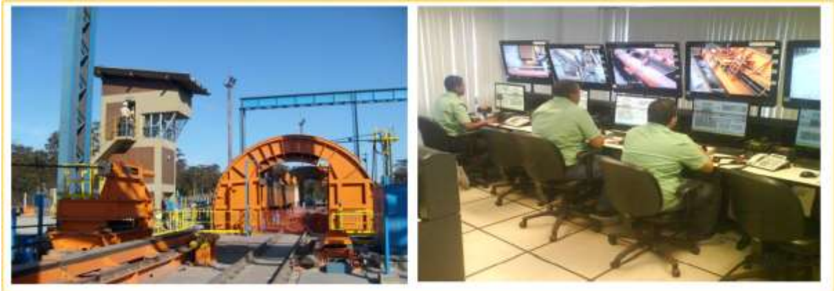
Figura 7 - Evolução da operação dos viradores de vagões (da cabine para sala de controle)
