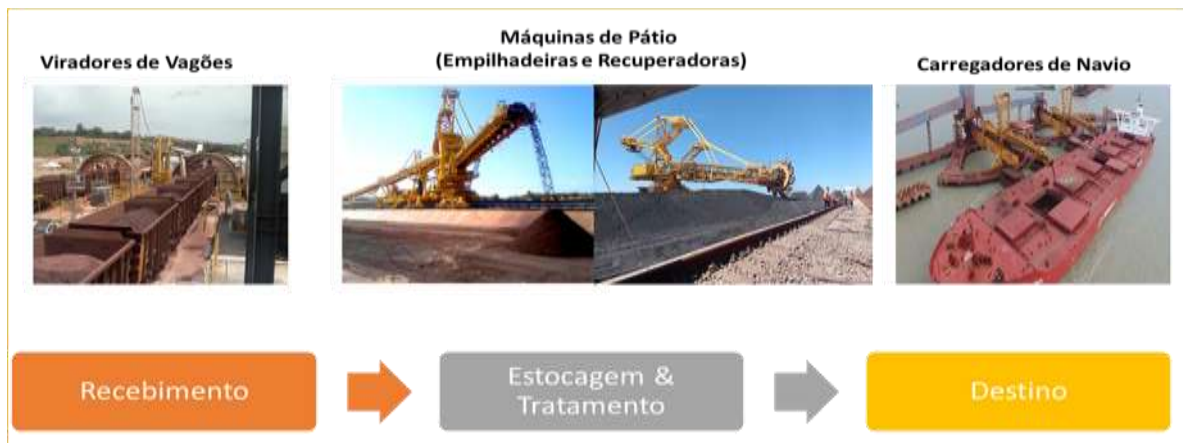
Figura 4 - Principais processos e equipamentos da cadeia produtiva do TMPM
