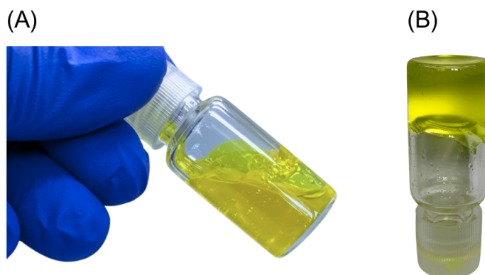
Figura 34: Formulação nGPC, evidenciando o comportamento termorresponsivo: (A) formulação à temperatura de 15°C com transição sol-gel e (B) formulação gel à temperatura de 27°C.
