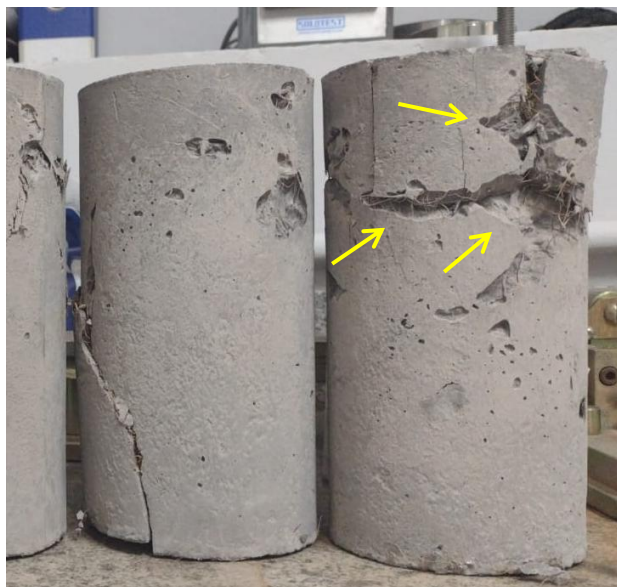
Figura 16: Amostras F2,51 após ensaio de compressão. Com sinalizações das áreas que ocorreram acúmulo de ar devido à ausência de vibração das amostras.
