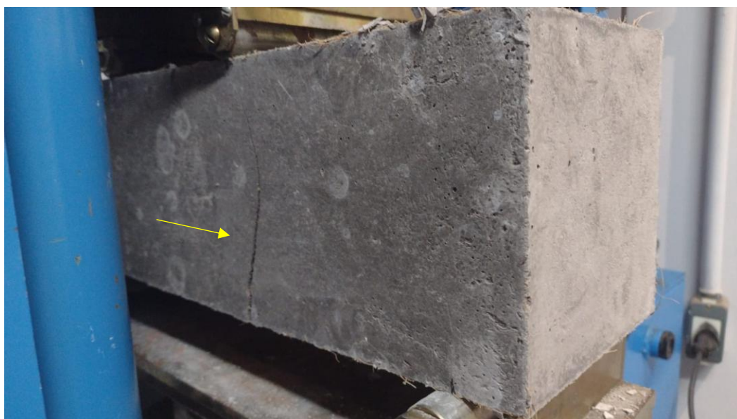
Figura 18: Fotografia após a realização do ensaio de flexão. Destacando a ruptura parcial impedida pela FCV
