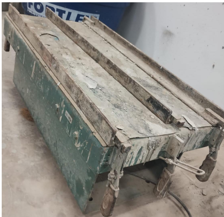
Figura 12: Mesa vibratória usada para reduzir as bolhas de ar no interior das amostras
