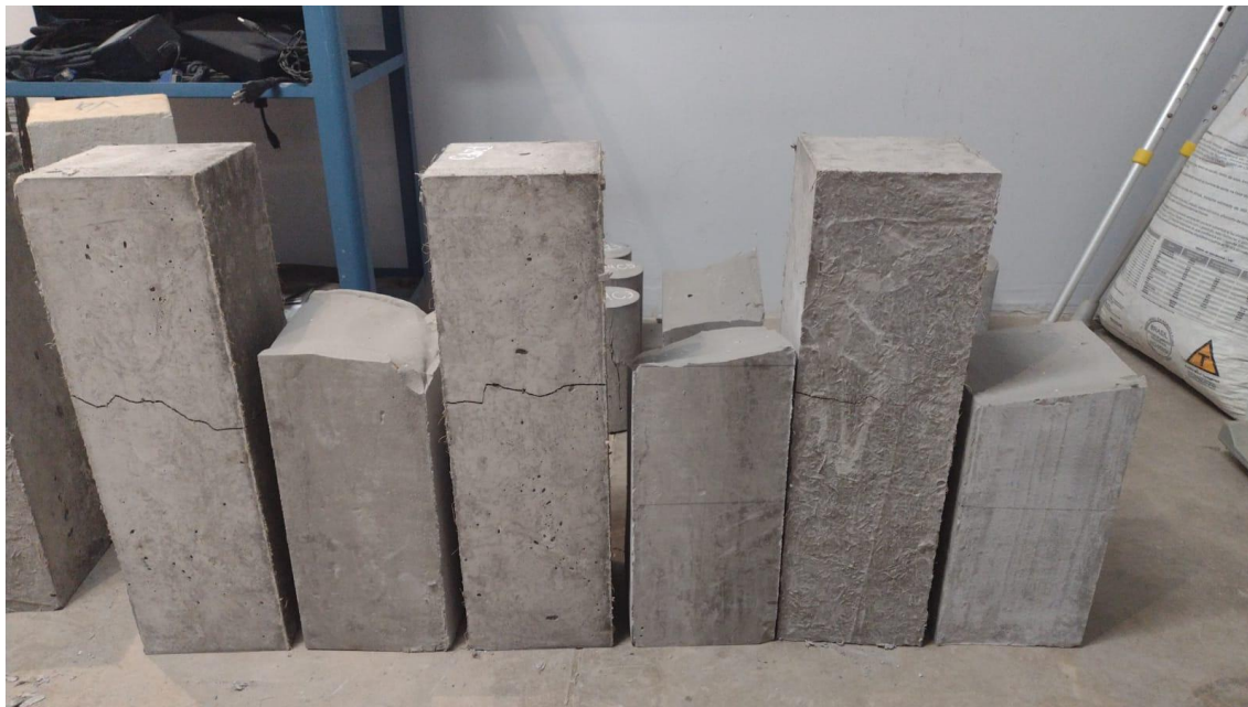
Figura 19: Comparação entre rupturas das amostras dos que possuem e não possuem FCV em sua composição
