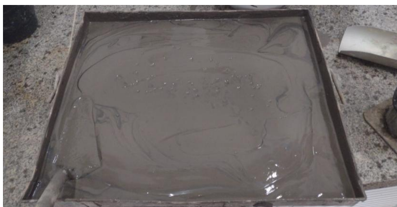
Figura 11: Consistência da argamassa produzida
