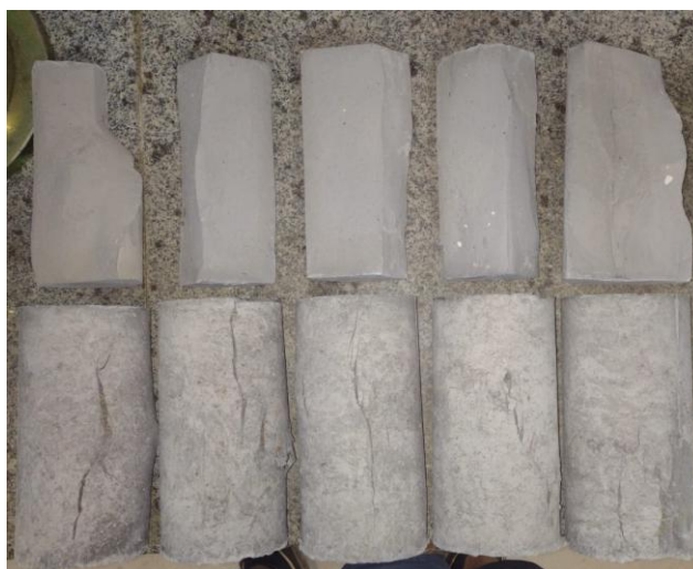
Figura 17: Comparação entre rupturas das amostras do grupo P (fileira superior) e grupo F2,4 (fileira inferior)
