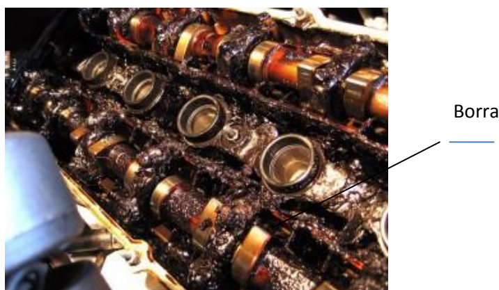
Figura 5 – Ilustração Motor diesel com borra de óleo – uma das causas pode ser ocasionada por combustível de má qualidade.
