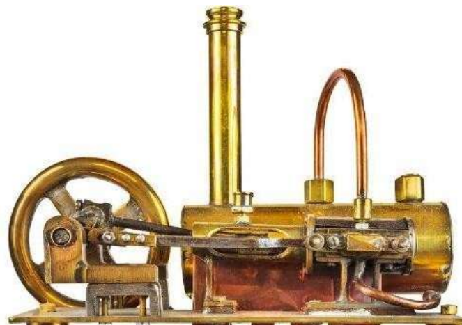
Figura 22: Uma máquina a vapor simples.
