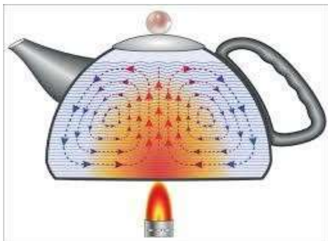
Figura 16: Correntes de convecção criadas na água de uma chaleira no fogão
