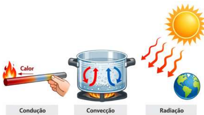
Figura 1 – Mecanismos de transferência de calor
