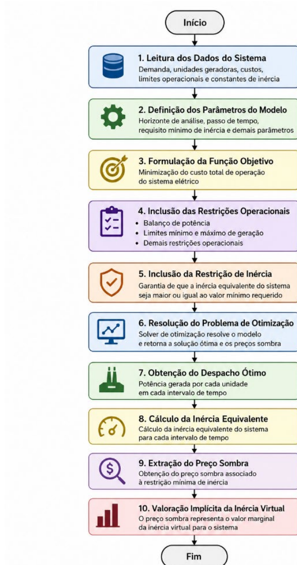
Figura 3.2 – Fluxograma do procedimento computacional utilizado para obtenção do despacho ótimo e da valoração implícita da inércia virtual. Fonte: Autor.
