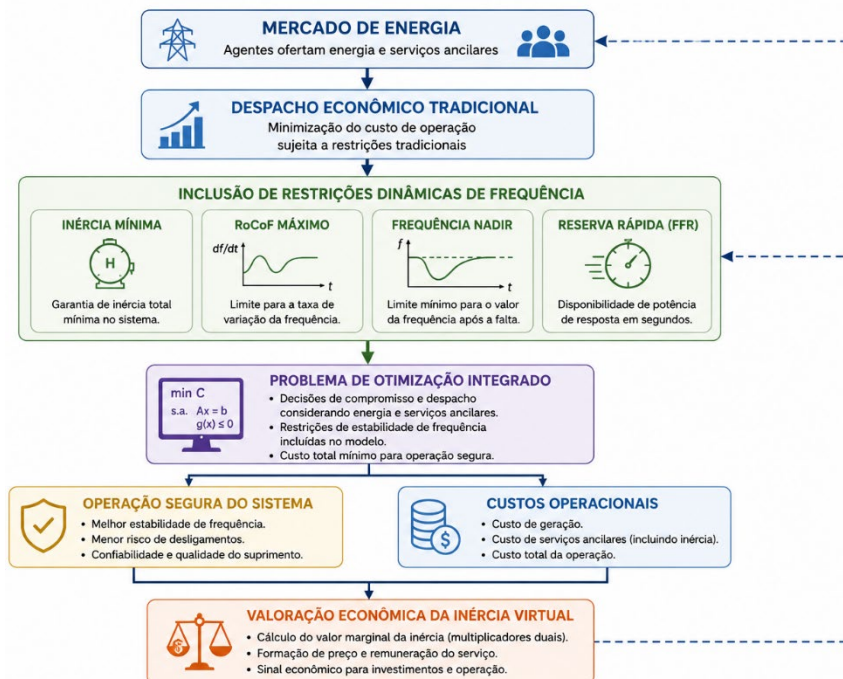
Figura 2.9 – Integração entre requisitos de estabilidade de frequência, despacho ótimo e valoração econômica da inércia virtual em sistemas elétricos modernos. Fonte: Autor.
