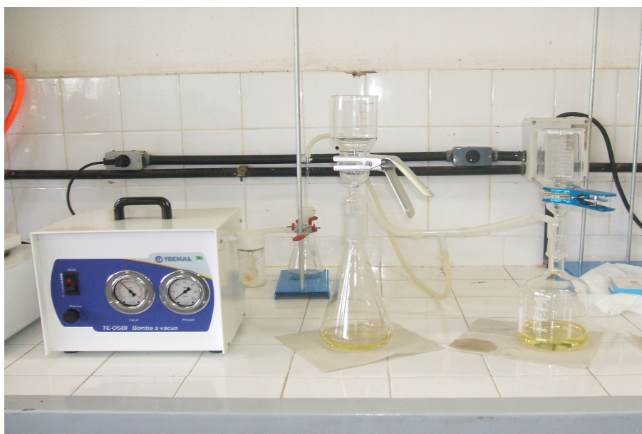
Figura 14. Sistema empregado na filtração do óleo de babaçu após clarificação.
