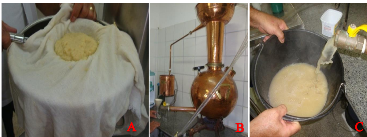
Figura 14: Separação de resíduos sólidos após fermentação (A), destilação de aguardente obtida a partir de amido de mandioca (B) e resíduos após destilação (C) Fonte: (AUTOR)
