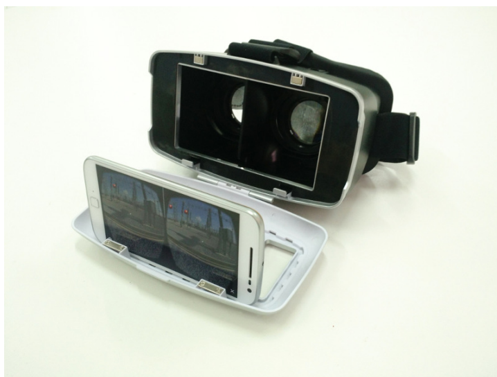
Figura 25 – Óculos de realidade virtual com abertura para visão de realidade aumentada utilizado: VR Box.
