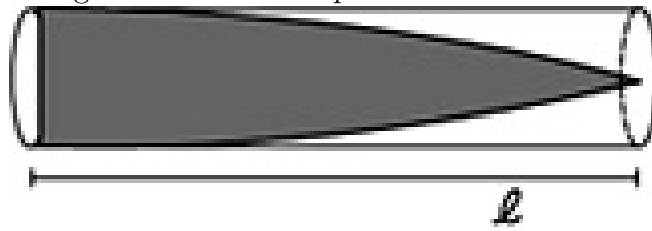
Figura 3.9: Tubo frequência fundamental.
