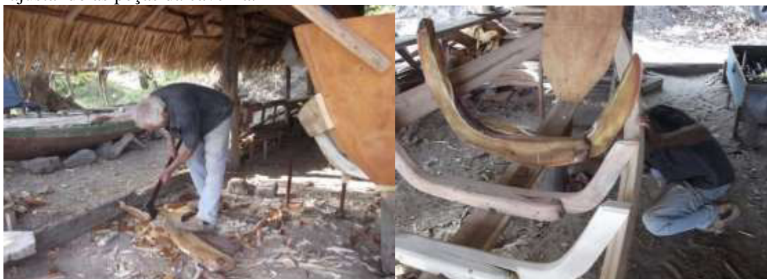
Figura 32 – Zé do Chá construindo uma peça da caverna de uma canoa e, na sequência, ajustando as peças da caverna.
