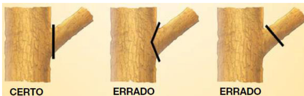
Figura 15 - Ângulo e posição correta do corte em podas
