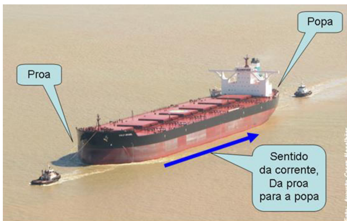
Figura 16. Demonstrativo do sentido da corrente em relação à manobra do navio.
