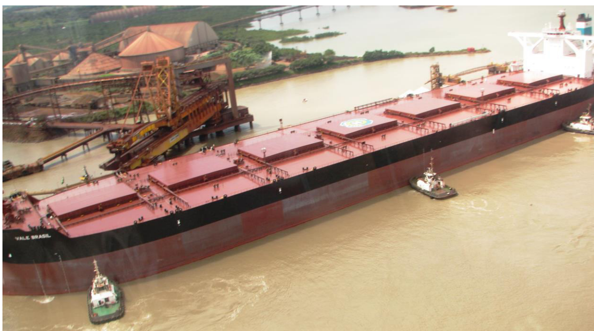
Figura 25. Rebocadores em “Push Pull” [Foto do autor].
