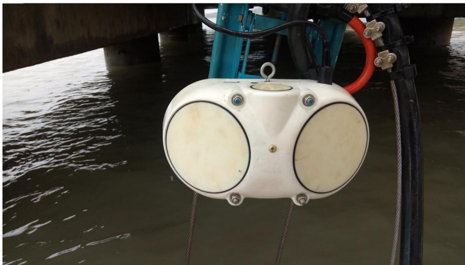
Figura 5. Perfilador horizontal acústico de correntes instalados no TPM [Fonte: Foto do autor, (2018)]
