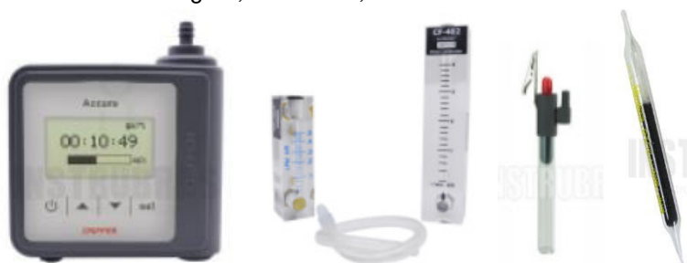
Figura 20 - Bomba de amostragem, calibrador, redutor de vazão e tubo de carvão ativado
