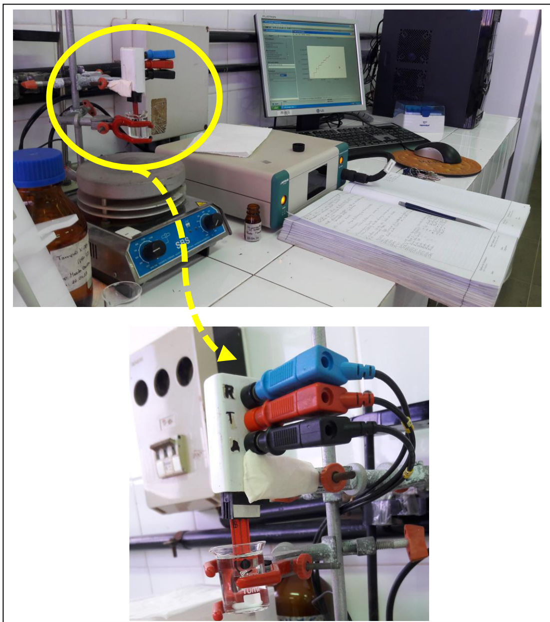
Figura B5 - Fotos do Potenciostato, com destaque para o conector feito sob encomenda para acoplamento do biossensor.
