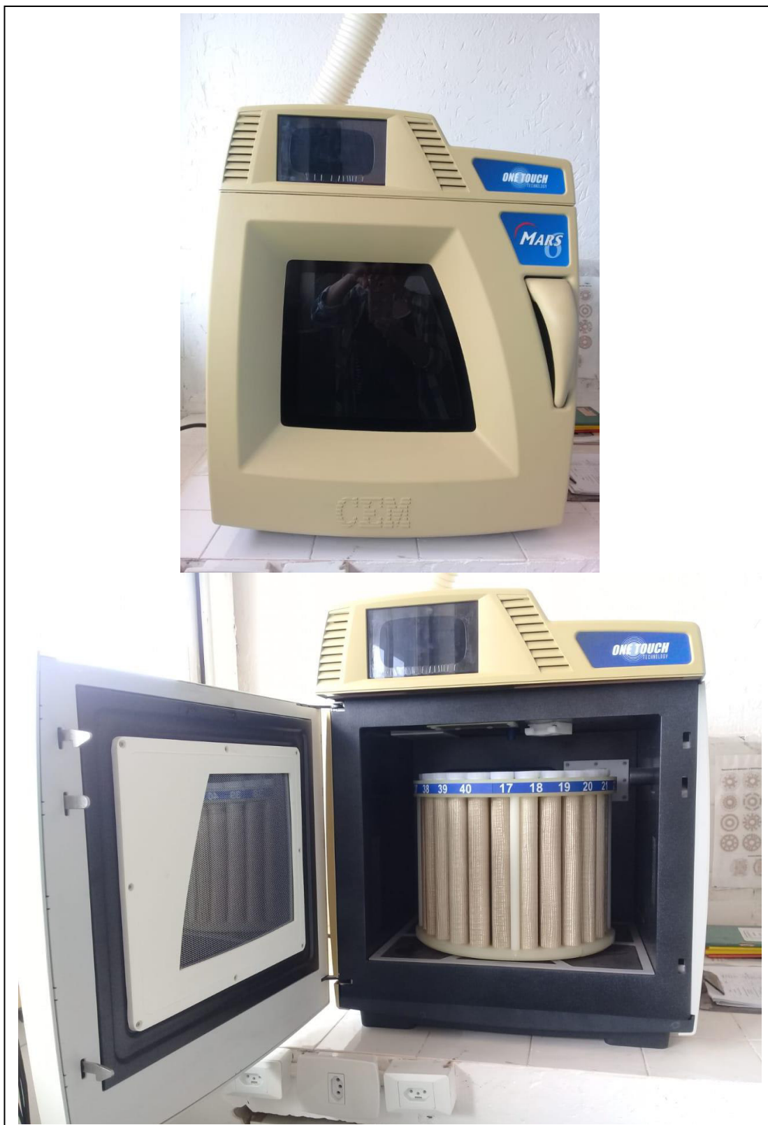
Figura B2 - Fotos do forno micro-ondas usado na extração dos minerais das amostras de frutos amazônicos. Destaque dado ao carrossel contendo os vasos de Teflon.
