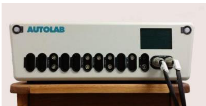
Figura 9. Autolab modelo PGSTAT 128 N utilizado para as medidas de espectroscopia de impedância eletroquímica (EIE). (Fonte: o próprio autor)
