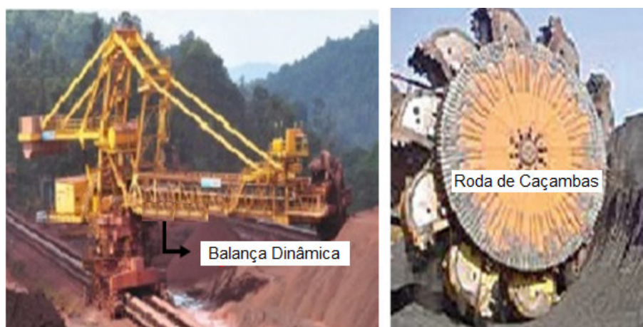
Figura 74 – Retomadora - em destaque a roda de caçambas.
