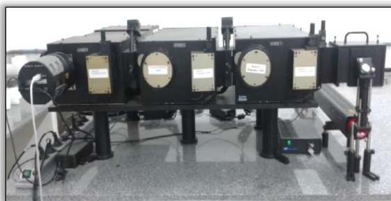
Figura 20 - Espectrômetro triplo Trivista 557 da Princeton Instrument (LER – UFMA).
