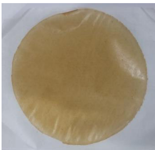
Figura 1. Biopolímero preparado com mesocarpo de coco babaçu, alginato, glicerol e reticulado com \text{CaCl}_2 \cdot 2\text{H}_2\text{O} .
