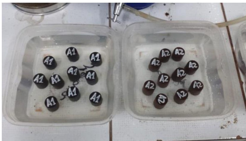
Figura 32: Amostras para teste de resistência à compressão axial.
