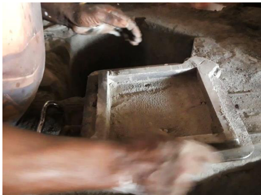
Figura 22: Aplicação da camada de secagem
