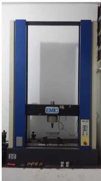
Figura 36: Teste resistência à flexão no EMIC DL10000
