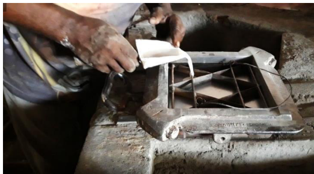
Figura 20: Disposição da calda pigmentada no molde
