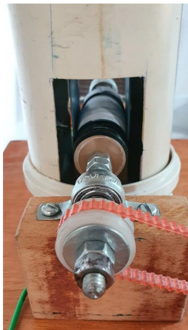
Figura 44: Eixo inferior alinhado com a abertura lateral da coluna de apoio (GVDG construído pelo autor).
