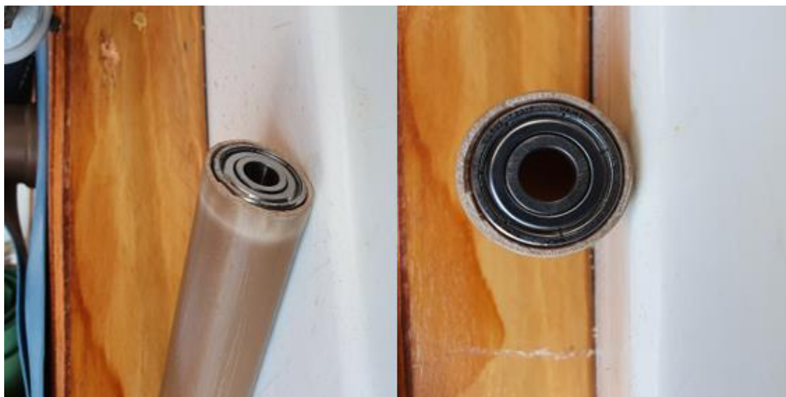
Figura 36: Rolamento de skate encaixado no cano de PVC usado no rolete superior.
