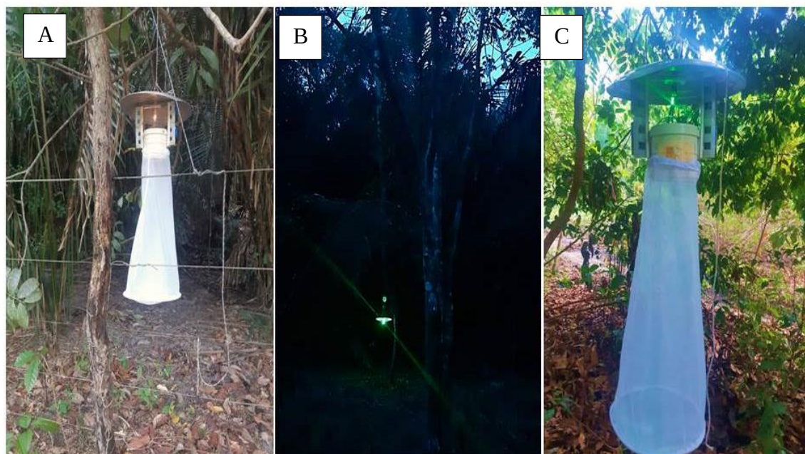
Figura 13. Armadilhas utilizadas no terceiro experimento. (A) armadilha HP com luz incandescente, (B) armadilhas Silva com LEDs na cor verde e (C) armadilha HP com LED na cor verde. Fonte: E.C.Araujo.
