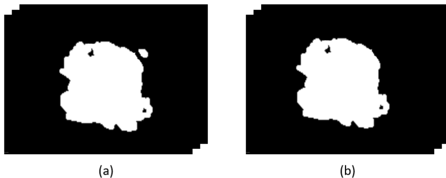
Figura 41 – Obtenção do maior volume encontrado na imagem dilatada. (a) Imagem de entrada e (b) imagem com o maior volume.
