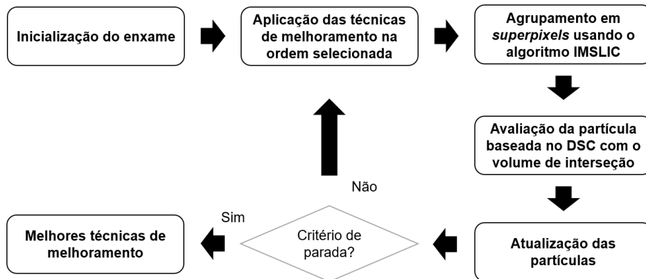
Figura 27 – Fluxograma da etapa de melhoramento baseado no algoritmo PSO.
