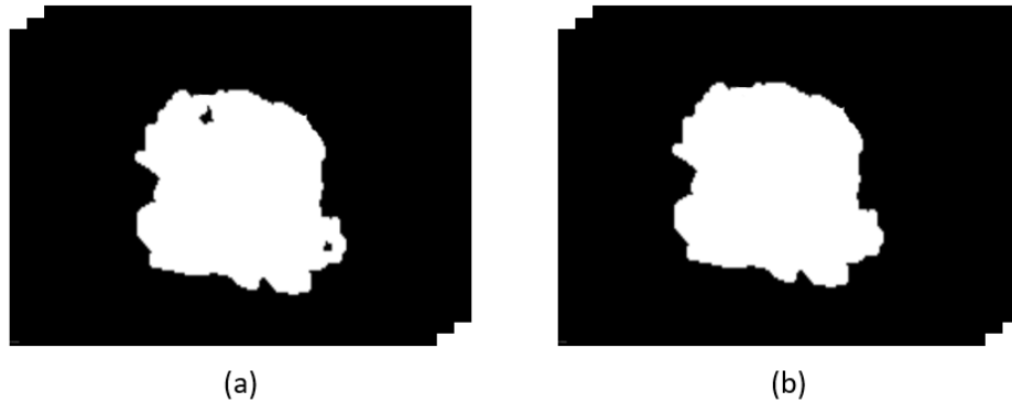
Figura 42 – Aplicação da operação de preenchimento de buracos. (a) Imagem de entrada e (b) imagem com a aplicação do preenchimento de buracos.
