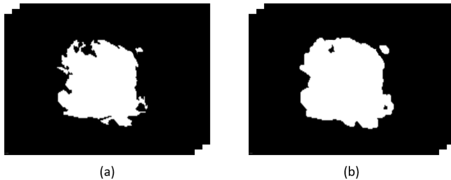
Figura 40 – Aplicação da dilatação na imagem segmentada. (a) Imagem de entrada e (b) imagem dilatada.
