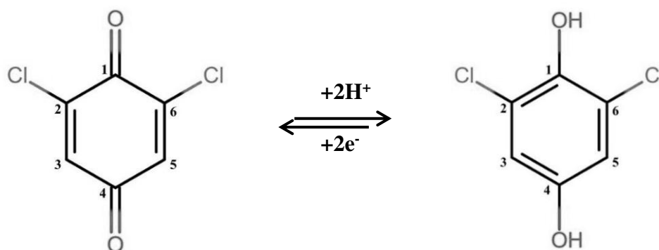
Figura 19: Equação de oxirredução da 2,6-DCBQ (adaptado [8]).
