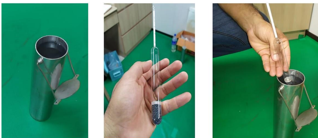
Figura 13- Coleta de amostra de água para análise de densidade Fonte: O autor
