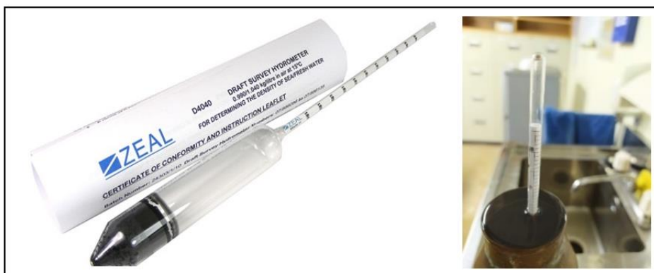
Figura 14 – Densímetro de vidro Zeal para Draft Survey Fonte: Zeal, 2022
