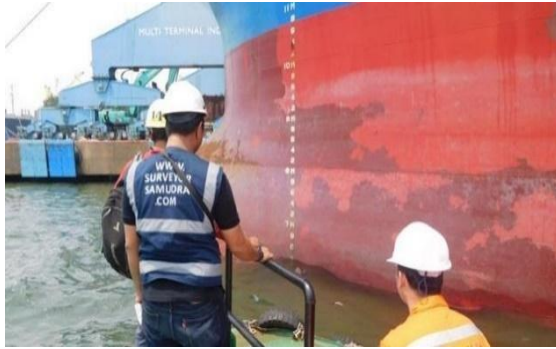
Figura 9: Realização de leitura de calados (drafts) por arqueadores de navios para verificação do nível de imersão da embarcação.
