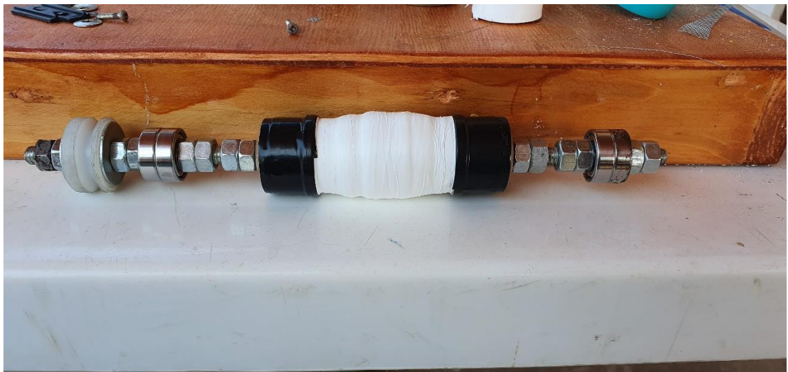
Figura 41: Rolete inferior já com o sistema de contraporcas e polia.
