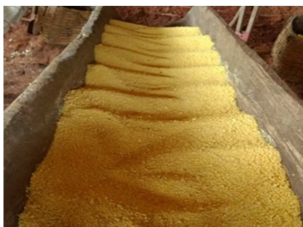
Figura 15 – Imagem do processo de resfriamento da farinha é feito utilizado cocho de madeira.
