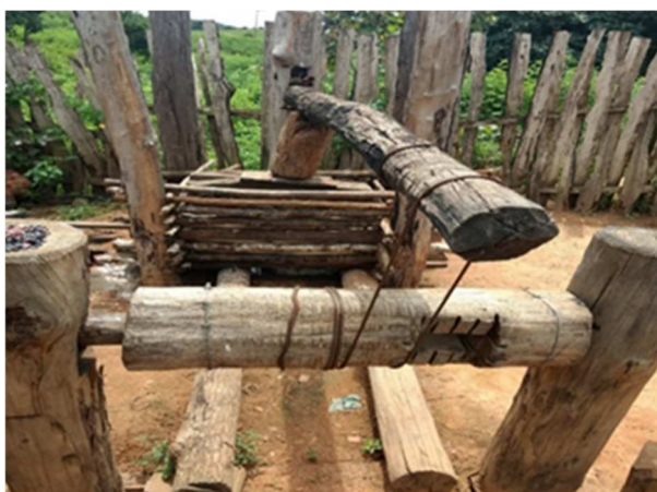
Figura 12 – Imagem da prensa de madeira utilizada no processo de prensagem da massa da mandioca.
