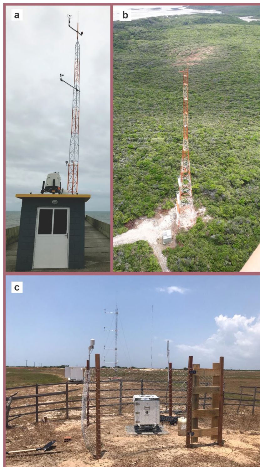
Figura 3.2: Equipamentos utilizados para aquisição dos dados observacionais. (a) LIDAR-SC modelo Zephir 300 (b) TORRE-MA com anemômetros RM Young modelo 86000 (c) LIDAR-MA modelo WindCube V2 da Leosphere
