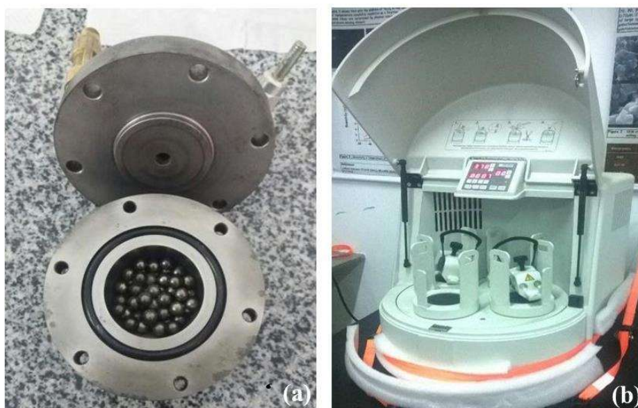
Figura 19. (a) Painéis com as esferas de aço utilizadas para a moagem das amostras. (b) Moinho Planetário.
