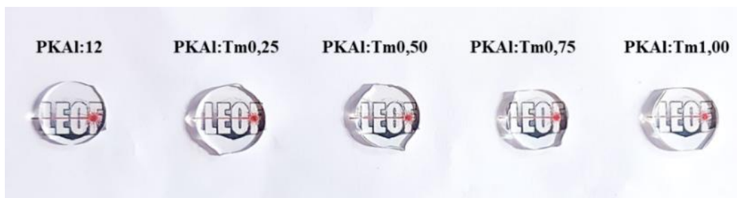
Figura 5.1 – Fotografia das amostras base PKAl:12 e PKAl:Tm com 0,25 a 1,00 %mol de \text{Tm}_2\text{O}_3 após corte e polimento óptico. A imagem mostra o logo LEOF para demonstrar a alta transparência das amostras sintetizadas.
