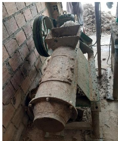
Figura 57: Máquina sem proteção
