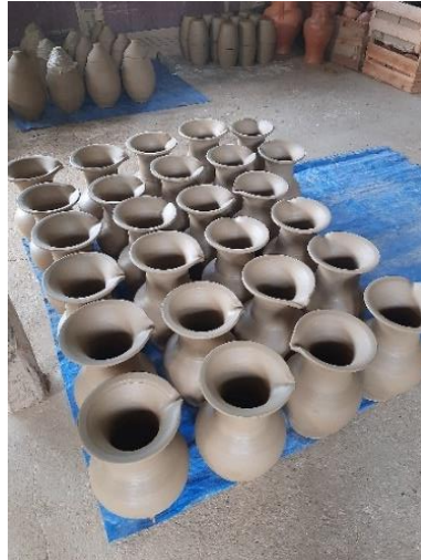
Figura 20: Secagem no chão
