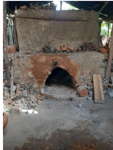
Figura 25: Forno do tipo caieira
