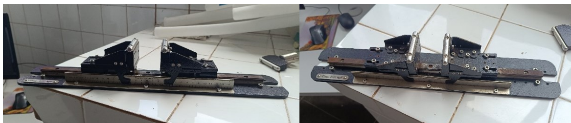
Figura 28 - Dispositivo de Flexão para ensaios
