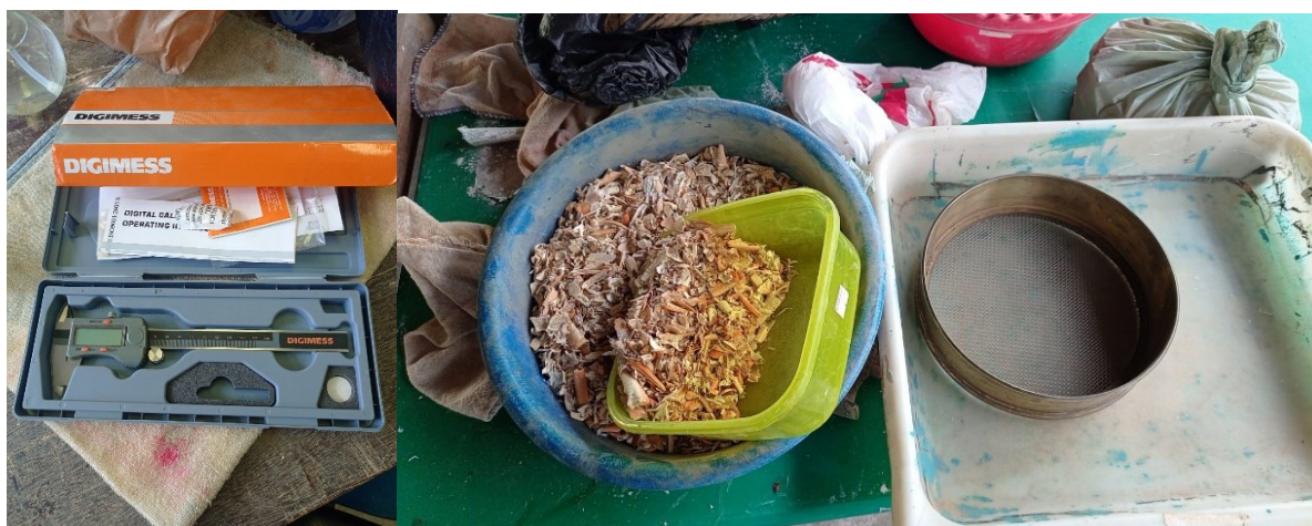
Figura 16 – Paquímetro digital, peneira metálica e recipientes utilizados para manipular as matérias-primas
