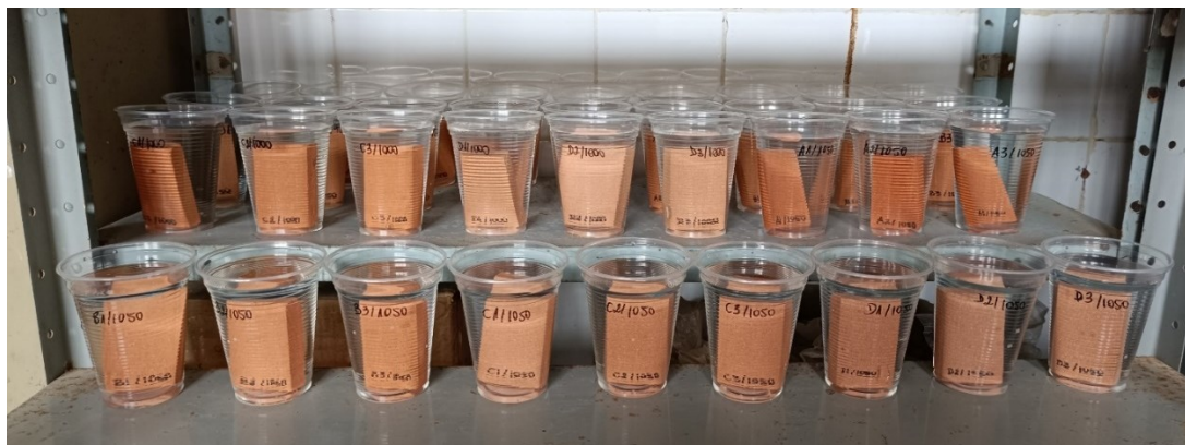
Figura 26 - Ensaio de absorção de água
