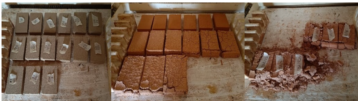
Figura 30 - Primeira remessa de amostras a 850 °C
