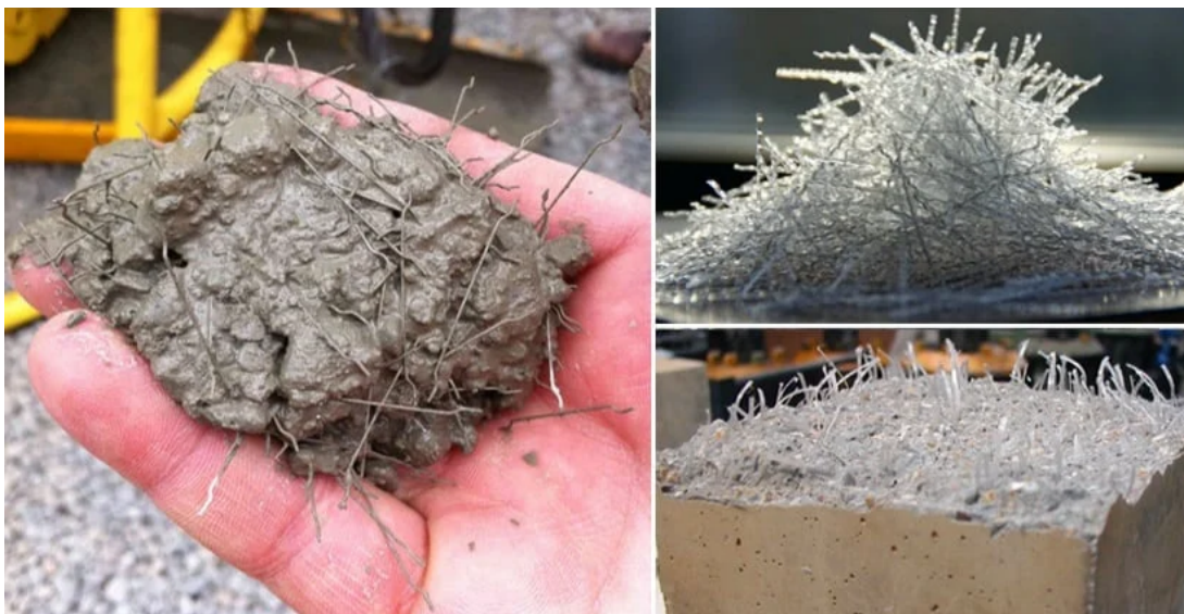
Figura 1 – Exemplos de concreto reforçado por fibras.
