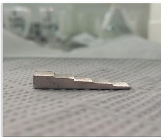
Figura 8- Penetrômetro de alumínio utilizado na análise de radiopacidade.
