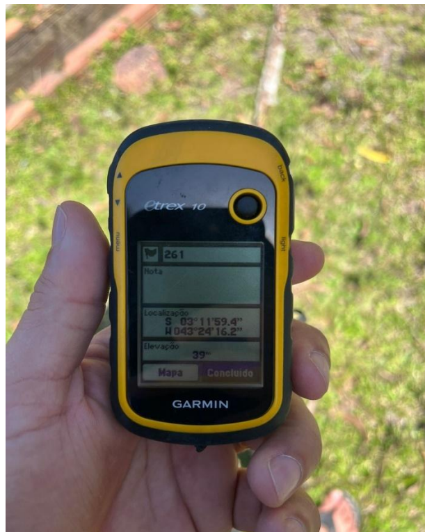
Figura 7: Georreferenciamento de pontos com GPS (GARMIN – Etrex 10)
