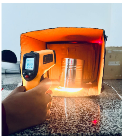
Figura 21 – Prática experimental sobre o comportamento de um corpo negro
