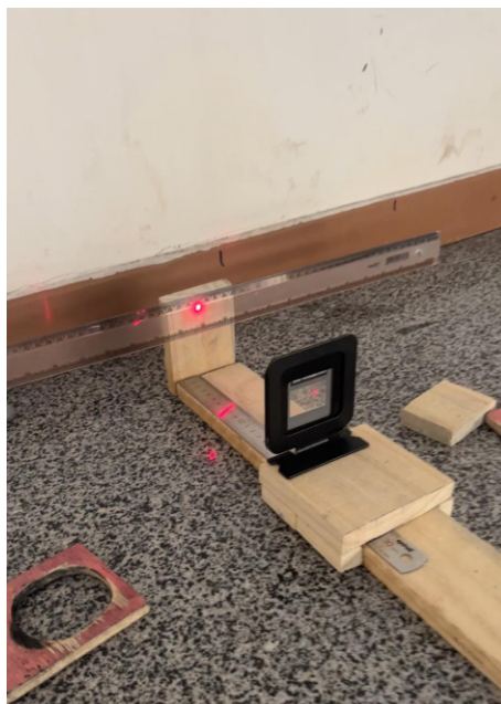
Figura 33 – Medição com a rede de difração laboratorial
