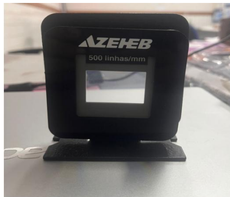
Figura 10 – Rede de difração laboratorial da marca Azeheb
