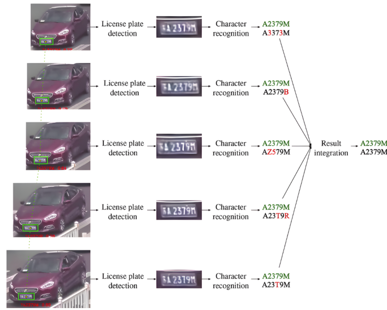
Figura 7 – Estrutura do sistema LPR baseado no rastreamento de veículos e na integração de resultados. Fonte: (ZHU et al., 2019)
